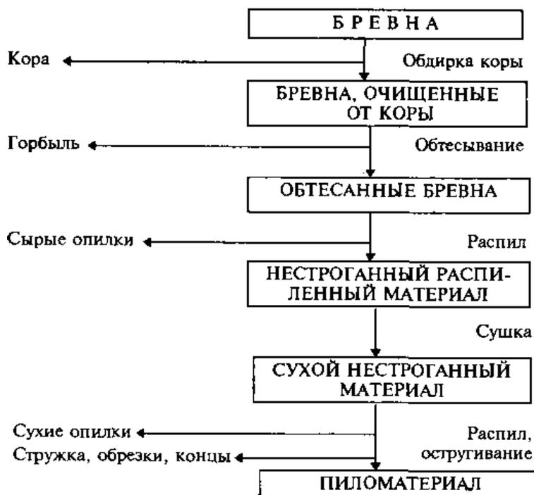
Рисунок 2 – Технологическая схема лесопильного производства
