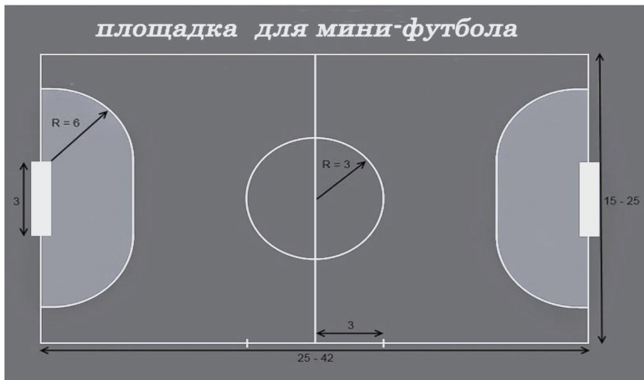
Рисунок 2 - Схема с габаритными размерами площадки для игры в мини-футбол
