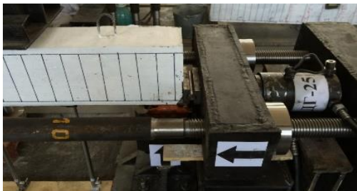
Рис. 2. Узел сопряжения железобетонной балки и торцевой траверсы: траверса (1); железобетонная балка (2); металлическая пластина (3); труба сплошного сечения (4).
