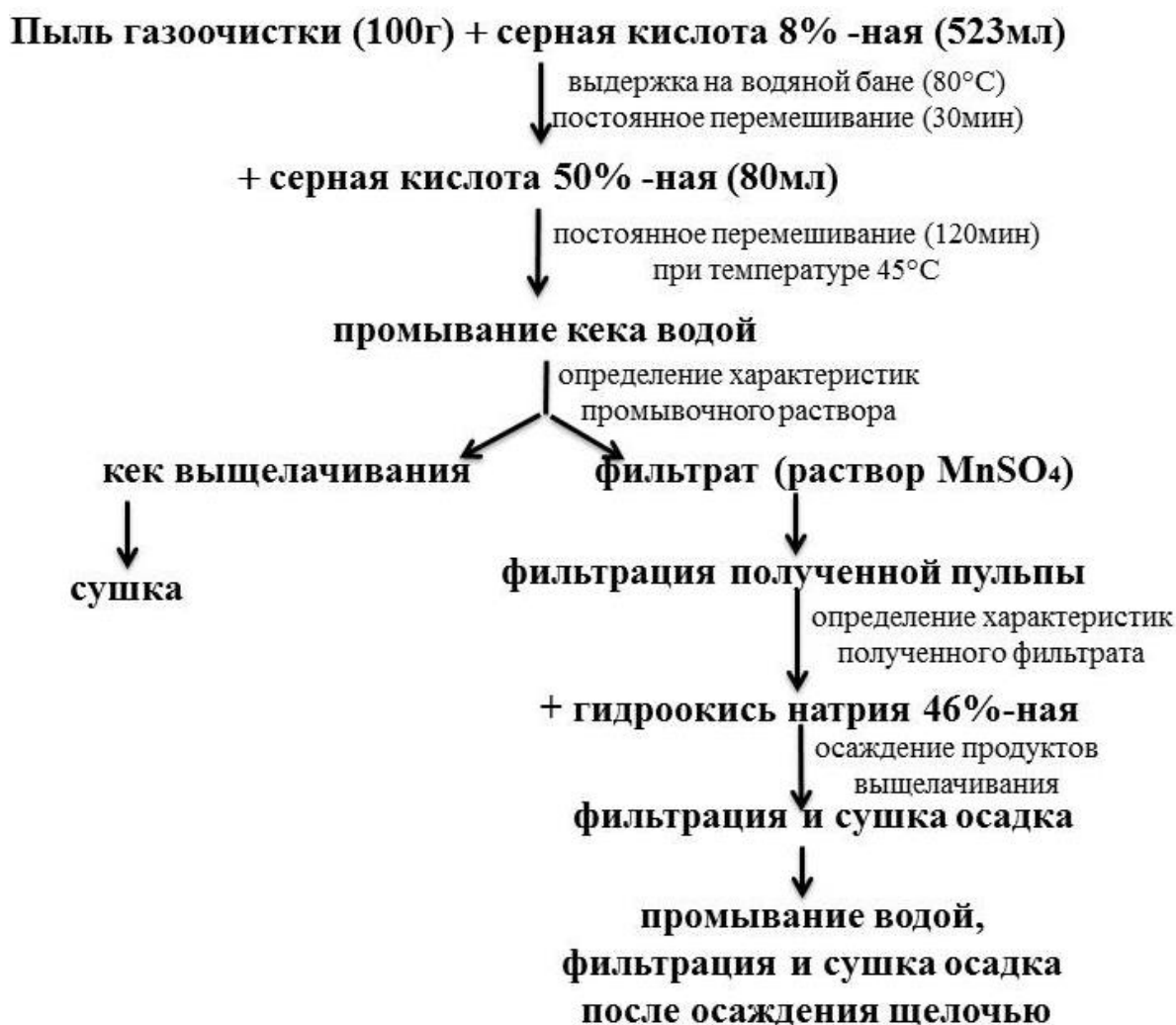
Рисунок 4 – Схема сернокислого выщелачивания. Опыт №3
