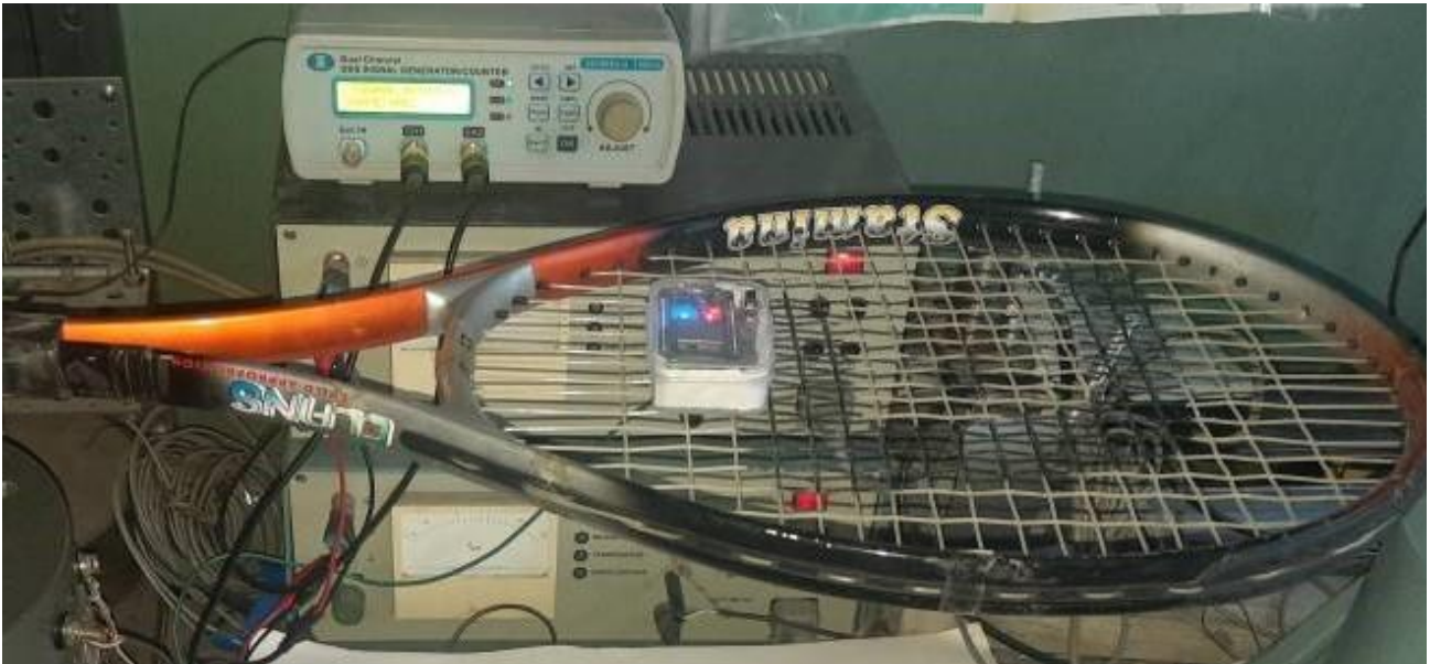
Рис. 1. Беспроводной датчик в момент записи динамических характеристик струн теннисной ракетки.
