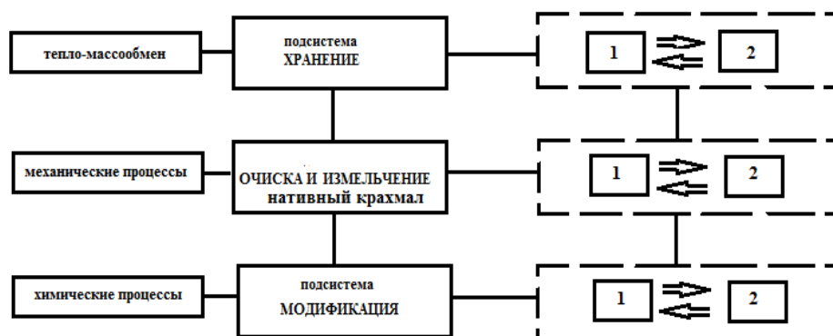
Рис. 1 – Схема комплектования технологической линии с учетом вариативности принимаемых решений для отдельных подсистем
