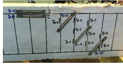
Рис. 4. Схема размещения датчиков деформации в наклонном сечении. на арматуре (а), (в); на бетоне (б), (г)
