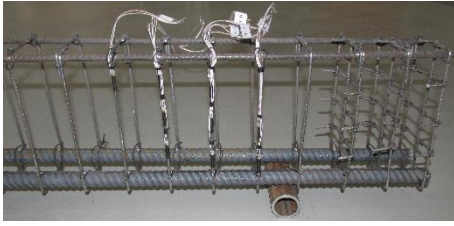
Рис. 4. Схема размещения датчиков деформации в наклонном сечении. на арматуре (а), (в); на бетоне (б), (г)
