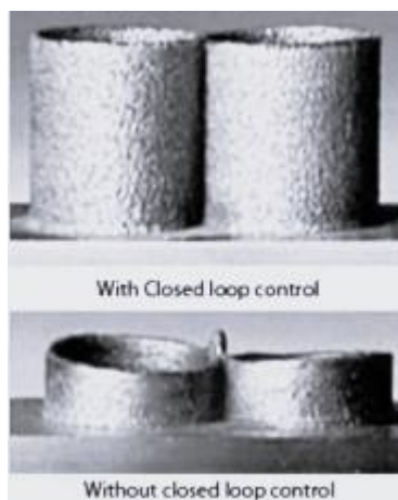
Рисунок 10 - Пример изготовления с замкнутым контуром управления и без управления с обратной связью
