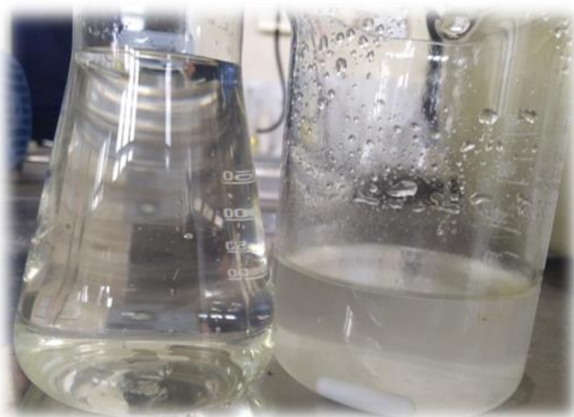
Рис. 1. Раствор дизельного топлива в воде до очистки (справа) и после очистки (слева)
