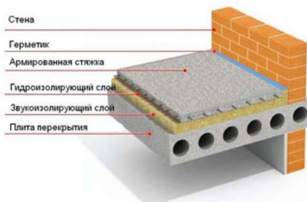
Рисунок 1 – устройство плавающего пола
