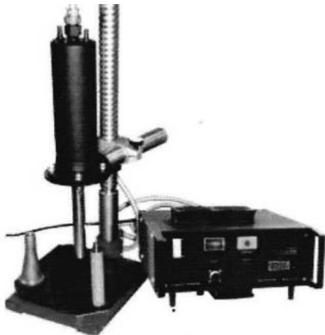
Рис. 1. – Ультразвуковая лабораторная установка (диспергатор)
