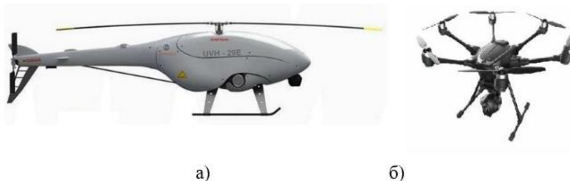
Рисунок 2 - Винтокрылый беспилотный летательный аппарат: а) Вертолет; б) Многовинтовой летательный аппарат
