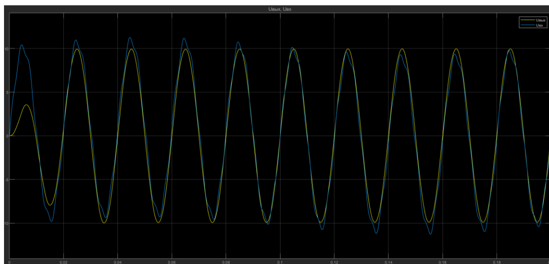
Рис.11 Показания осциллографа при наличии помех во входном сигнале.
