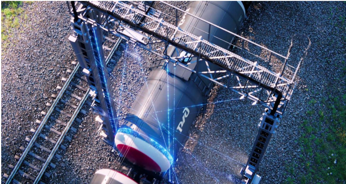
Рисунок 1 - Пост автоматизированного приема и диагностики подвижного состава
