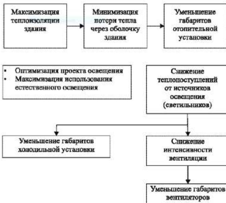
Рис. 1. Взаимозависимости компонентов здания как единой теплоэнергетической системы
