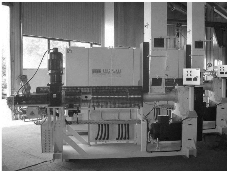
Рис. 1 технология получения изделий путём продавливания вязкого расплава материала или густой пасты через формующее отверстие [2]
