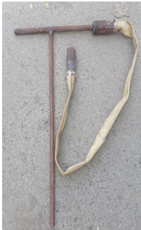
Рис. 2 Устройство для отогрева пожарных стояков гидранта
