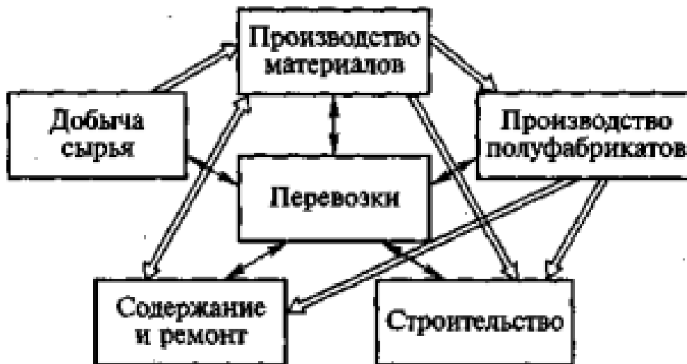
Рис. 1. Схема системы производств в дорожном строительстве и транспортных услуг
