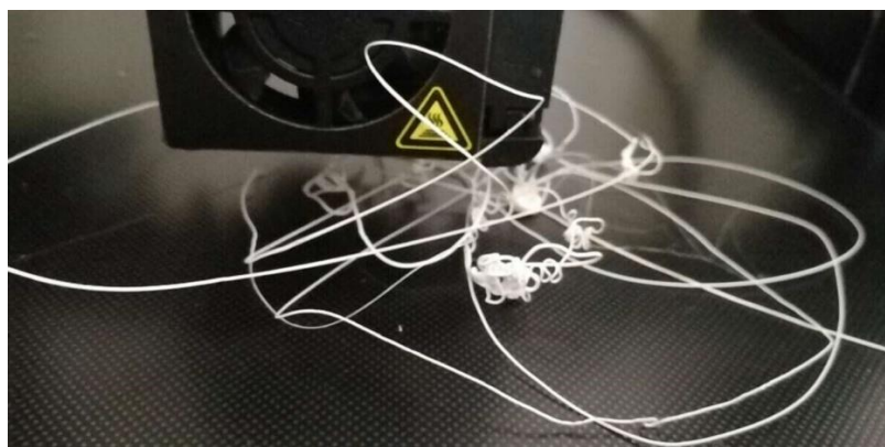
Рисунок 1 - Пример отсутствия адгезии пластика с поверхностью стола
